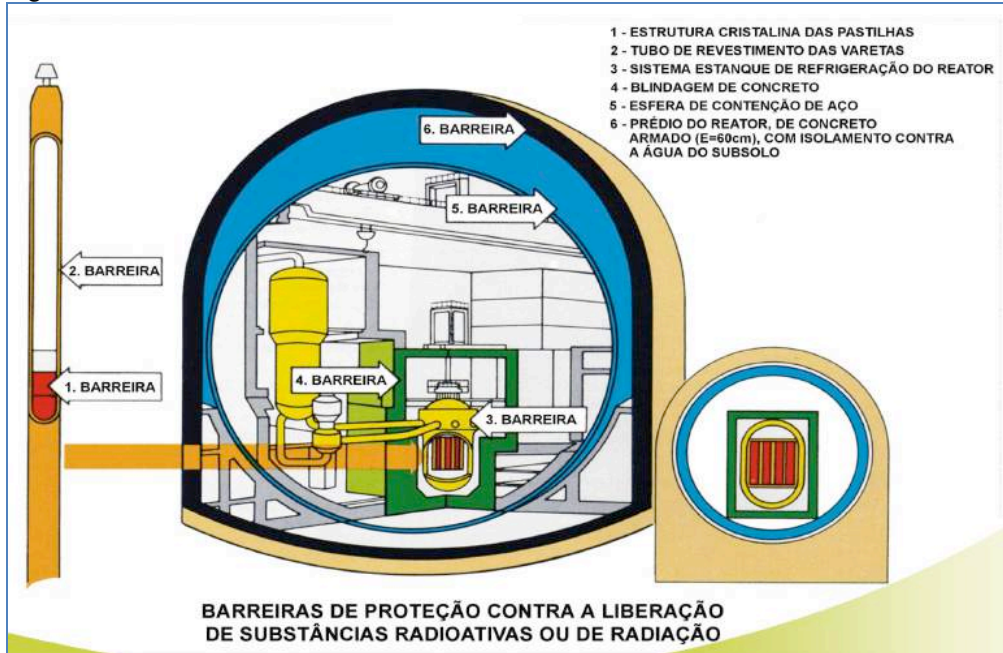
Figura 4: Barreiras de um reator nuclear PWR
