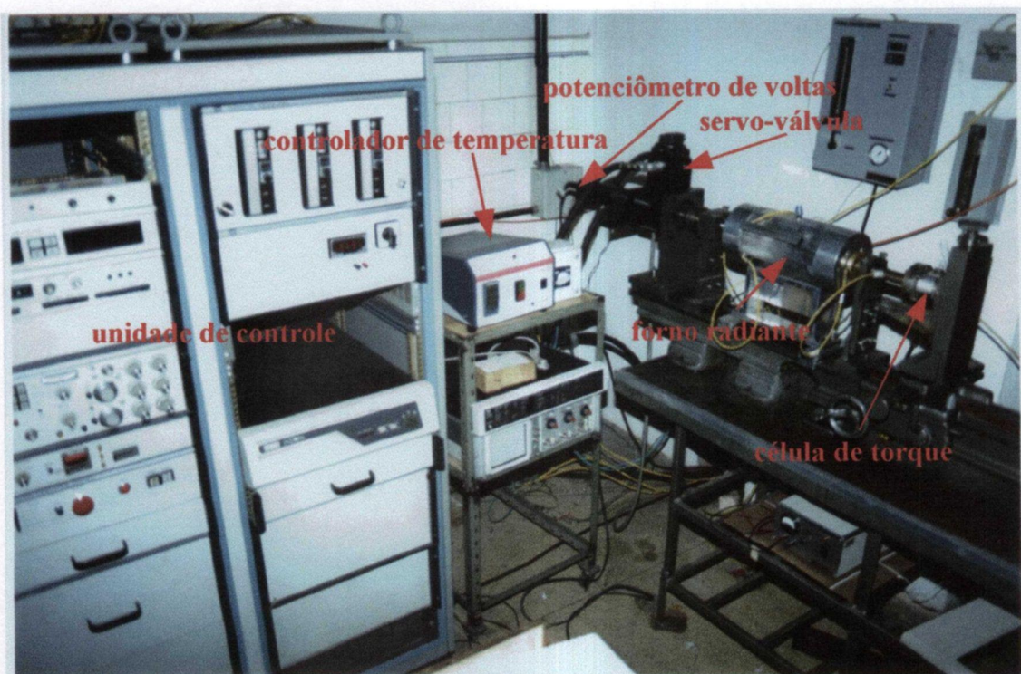
Figura 7 Unidade de torção do departamento de Engenharia Metalúrgica de UFMG, utilizada neste trabalho.
