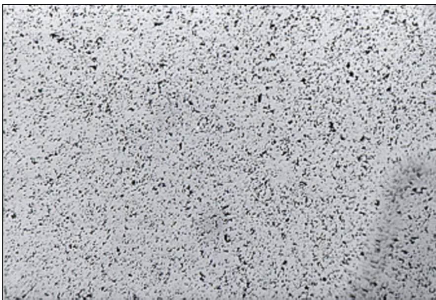
Figura 5.34 - Microestruturas otimizadas de pastilhas de (\text{Th},5\%U)\text{O}_2 .
