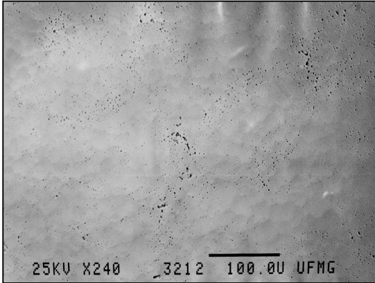
Figura 5.21 - Distribuição de poros não-uniforme de uma pastilha de (Th,5\%U)O_2 fabricada com microesferas calcinadas em bandeja.
