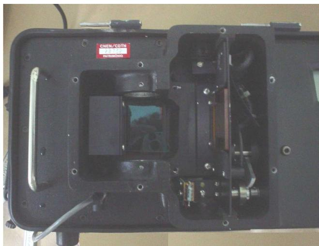
Figura 1: Fluorímetro aberto para limpeza dos filtros e substituição da cubeta.
