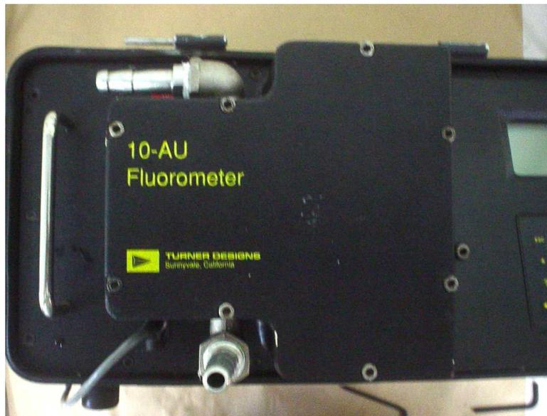
Figura 3: Fluorímetro com cubeta para fluxo contínuo.
