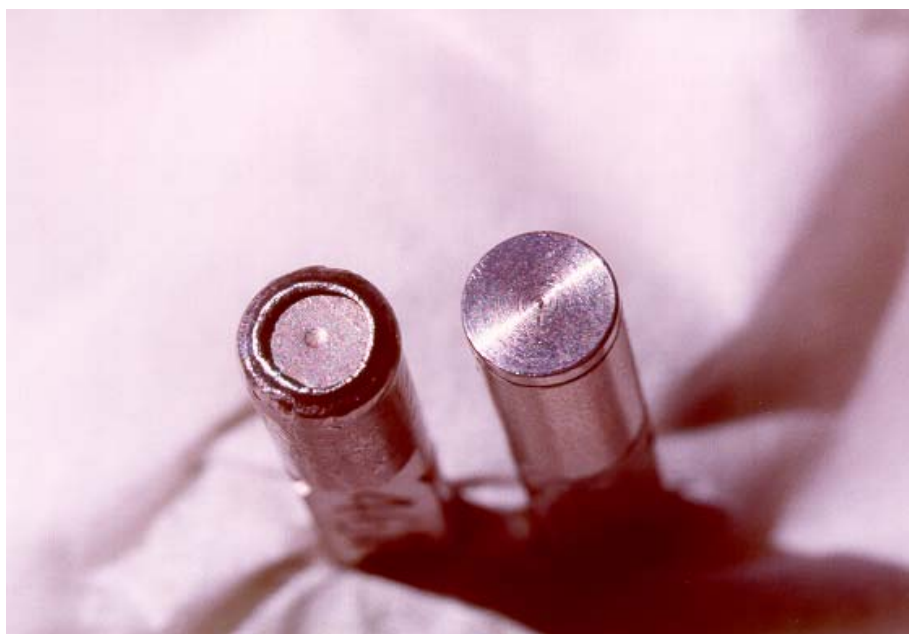
Figura 3.16 Detalhes das Cápsulas da Fig. acima. À Esquerda Fonte Soldada e à Direita Fonte Rebitada (atualmente só são produzidas fontes soldadas)
