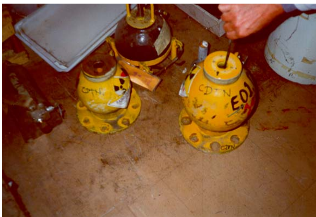
Figura 3.14 Ensaio de Esfregaço na Blindagem de um Medidor de ^{60}\text{Co}
