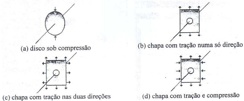
Figura 4. Ilustração dos tipos de modelos estruturais disponíveis.
